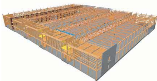
Fachwerkträger aus Bu-FSH spannen das Dachtragwerk auf: 82 m lange und 3,8 m hohe Haupt-Fachwerkträger in Längsrichtung mit nur einer Zwischenstütze, und 18,30 m lange Neben-Fachwerkträger quer dazwischen eingehängt. Zwei Querriegel, die Ostspange (vorne im Bild) und die Westspange, fassen die Halle ein. Isometrie: SWG Engineering
